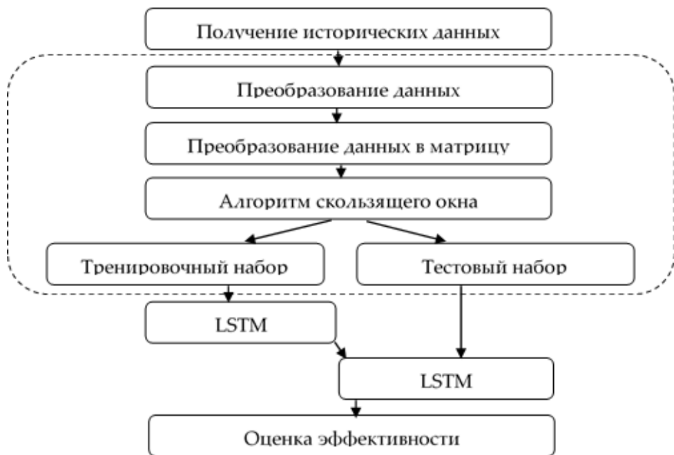
Рис. 2. Блок-схема этапов использования LSTM для прогнозирования акций
